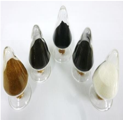
カシューパーティクル(カシュー摩擦調整材) Cashew Particles (Cashew friction materials)
